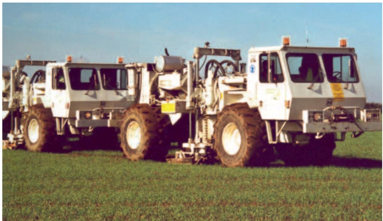
**Abbildung/Figur 4.5:** a) Grundschema reflexionsseismischer Messungen, b) Einsatz von Vibratoren als seismische Quelle.
