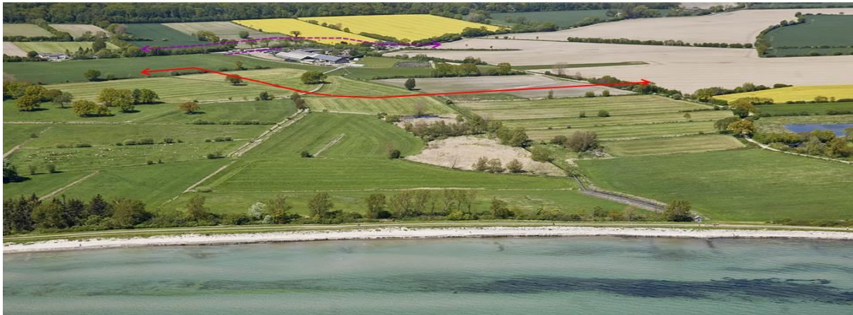
Abb. 159: Deich Vogelsang: Der alte Deichverlauf ist in violet, der Deich nach der Verstärkung in rot gekennzeichnet. VPS2015-109_264.7-265.2.jpg
