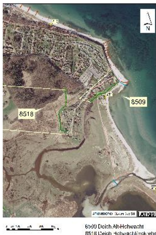
Abb. 114: Begrenzung des Küstenabschnittes 8518 Deich Hohwacht-Eckrehm LKN-SH 2012
